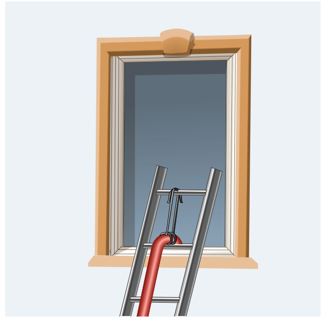
Leitung zwischen den Sprossen durchziehen und sichern
