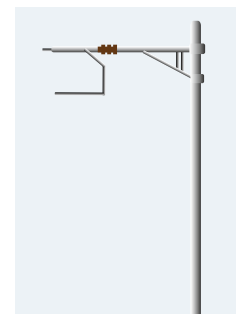
Fahrleitung, z.B. SBB 15 kV
