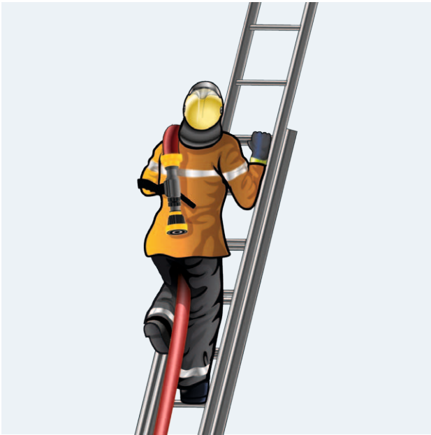
Besteigen der Leiter mit Druckleitung
