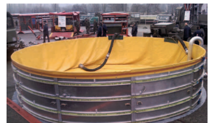
Auffangbehälter aus Aluminiumelementen, z.B. 50'000 l
